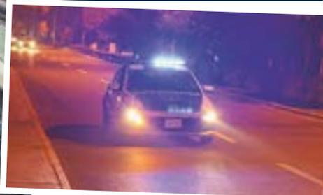
Son 105 automóviles equipados con luces LED azules de alta visibilidad, sirena, parlante externo, consola digital y dispositivos GPS de ubicación satelital. Cada unidad cuenta con cámaras que permiten hasta 720 horas de grabación continua y transmisión en tiempo real a la Central de Monitoreo. Además, se incorporan 4 camionetas del Grupo de Intervención Rápida (GIR), que patrullarán por el distrito.
