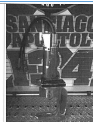
Equipos para rescate con más de 8 años de uso. El de la imagen tiene la hoja de corte dañada.
